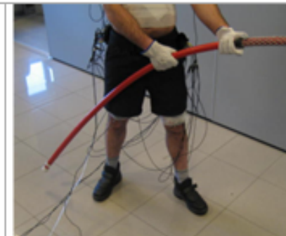
Ensayos de laboratorio para el estudio postural de tendido de cable
